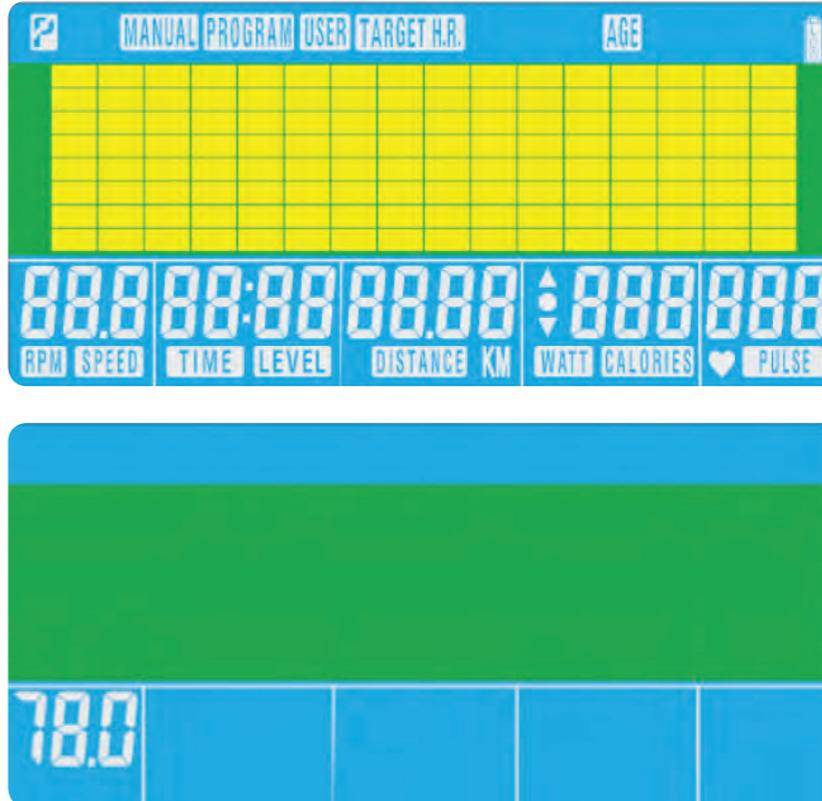
**02** O menu Main (Principal) é apresentado. O utilizador pode premir o botão START (INÍCIO) para começar de imediato no modo manual. Todos os valores (SPEED, DISTANCE, TIME) (VELOCIDADE, DISTÂNCIA, TEMPO) serão contados a partir de zero. O nível de resistência pode ser alterado a qualquer momento durante o exercício premindo os botões UP (PARA CIMA) ou DOWN (PARA BAIXO) .
